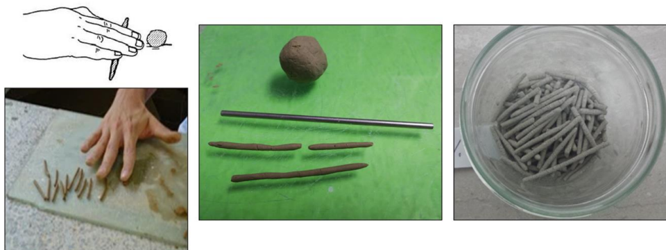
Figura 17 – Esecuzione del limite di plasticità.
