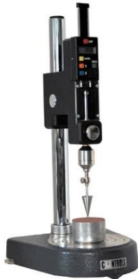
Figura 15 – Esempio di penetrometro a cono.
